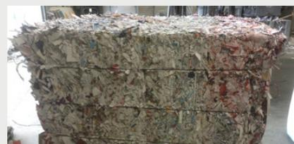
Des balles d'une tonne réduisant les besoins énergétiques, de main-d'œuvre et de consommables
